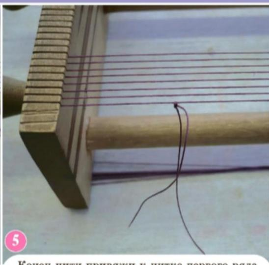
Конец нити привяжи к нитке первого ряда станка, отступив от левого края примерно 5 см. Сделай 2 - 3 узла. Станок готов к работе.
