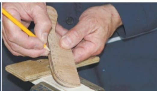
При помощи простого карандаша отложите 1–2 мм на краях заготовки по периметру.
