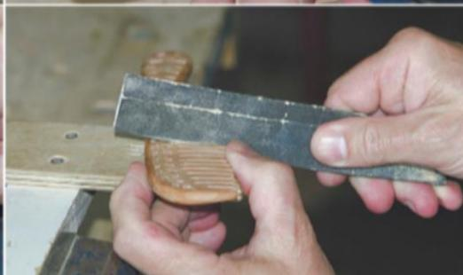
При помощи косого реза срежьте рёбра заготовки расчёски по разметке. Ошпите при помощи личного напильника рёбра расчёски по периметру.
