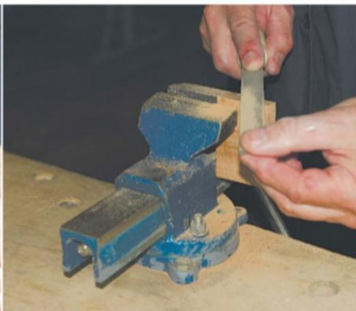
Разметьте деревянный чурок для последующей продольной распиловки. Можно взять готовую заготовку пужного размера из древесины следующих пород: яблоня, груша, вишня, слива, дуб.
