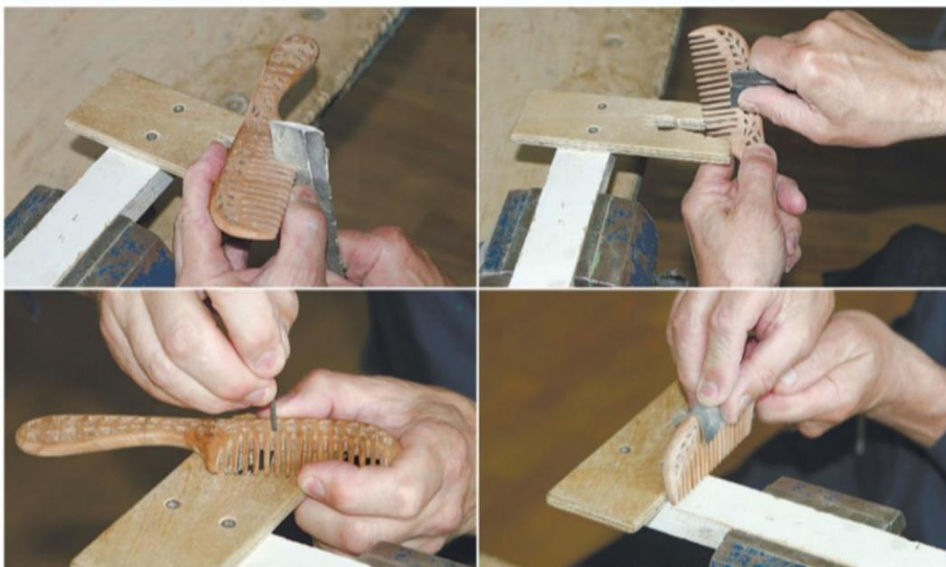
При помощи шкурки сточите на конус с двух сторон концы каждого зуба расчёски.
