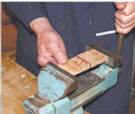
Подготовьте эпоксидный клей (можно заменить клеем «ПВА»). Произведите нанесение его на торцевую часть склеиваемых заготовок.
