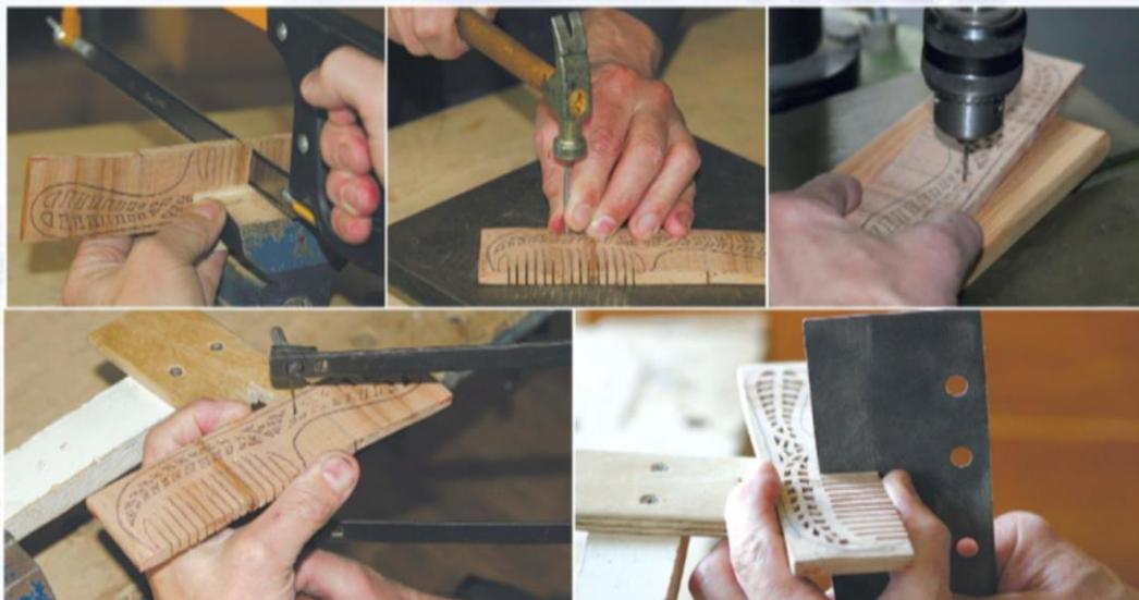
Надёжно зажмите заготовку в тисках перпендикулярно относительно губок, используя подкладки из кусочков фанеры. Продолжите аккуратно пропиливать промежутки будущих зубьев по запиленным ранее местам до отмеченной границы. Накерните места во внутренних элементах рисунка, просверлите отверстия.
